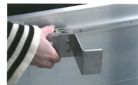
①設置金具をレールに取り付ける
