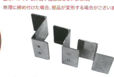
③ヒンジドアの隙間にプレートを挟みネジを回して固定 ※上下2か所に固定プレートがあります 設置金具は、商品を適正に固定させるものであり、 止水パッキンを押潰す機能はございません。 無理に締め付けた場合、部品が変形する場合がございます。
