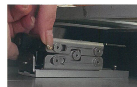
①ネジを回して設置金具のパネを緩める
